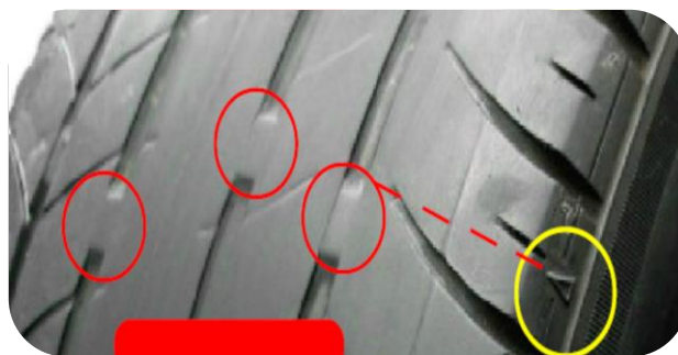
圖 8 輪胎殘溝已磨耗至指示平臺(需更換新胎)
