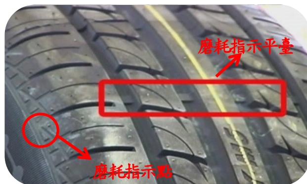
圖 7 輪胎磨耗指示平臺
