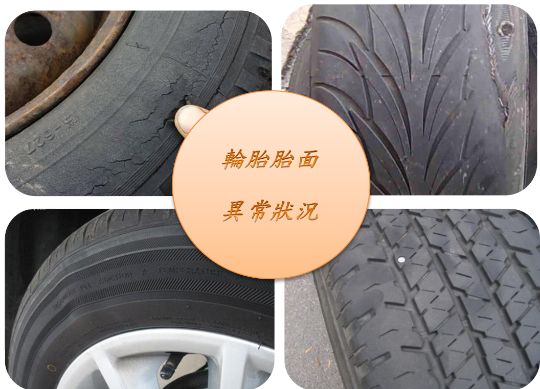
圖 9 輪胎胎面異常狀況(裂紋、不規則磨損、凸起、紮釘)
